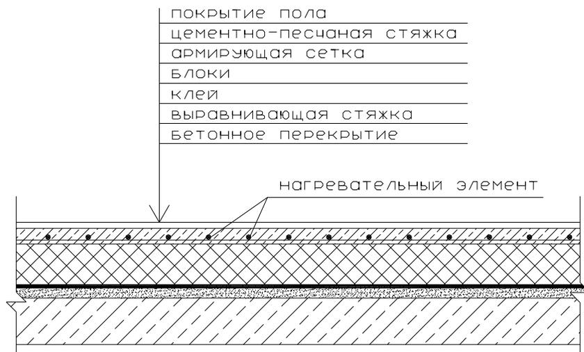
**Рисунок А.8 – Тепловая изоляция пола из блоков на перекрытии**
